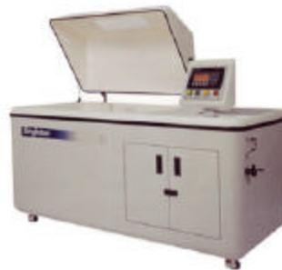
CCT - Cámaras cíclica para prueba de corrosión
