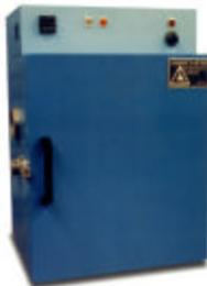
Cámaras walk-in con refrigeración hasta -73°C y máxima temperatura de 85°C con circulación forzada, sistema de humidificación, multi ventanas de observación, iluminación interior y salidas para PC. Especificación a su medida.
