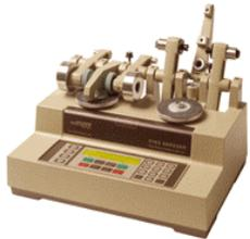
Equipo de abrasión de plataforma rotatoria
