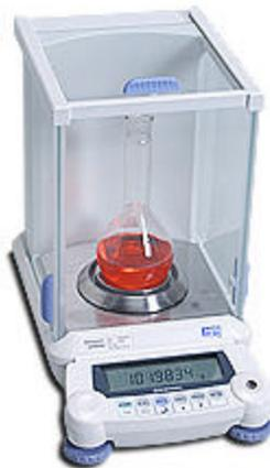
Balanzas semi - micro y analíticas con salidas Para ISO / GLP / GMP
