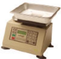
Equipo de abrasión oscilatoria ASTM F735
